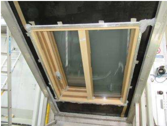
Bild 3 Abdichtung der offenen Fugen zur Nullmessung
