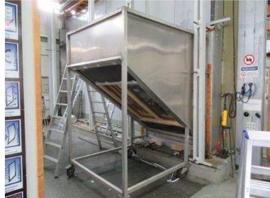
Bild 2 Probekörperaufbau mit Prüfbox auf Prüfstand
