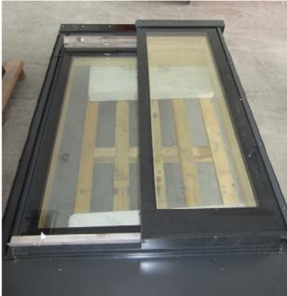
Bild 1 Dachflächenfenster vor Einbau in Prüfstand
